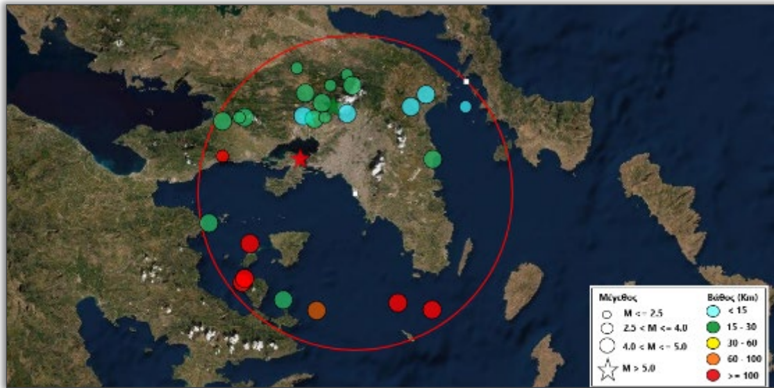
Σχήμα 6.4-6: Σεισμική Δραστηριότητα σε ακτίνα 50 km από την περιοχή του έργου για τα έτη 1964-2022 και για σεισμούς με μέγεθος Ms>4,0 Richter
